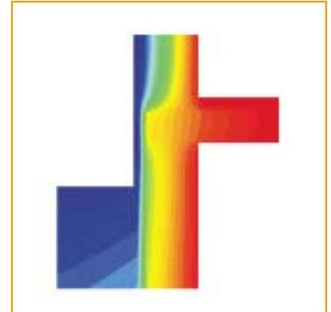
**Detail 2b:** Gleichwertig zu Bild B.9 Beiblatt 2. 60 mm Perimeterdämmung mit mindestens  $\lambda = 0,04 \text{ W}/(\text{m K})$ . Die Wärmeleitfähigkeit des Kellermauerwerks darf bis zu  $0,24 \text{ W}/(\text{m K})$  betragen. Wärmebrückenverlustkoeffizient  $\Psi_e \leq 0,07 \text{ W}/(\text{m K})$ . Auch für unbeheizte Keller möglich.
