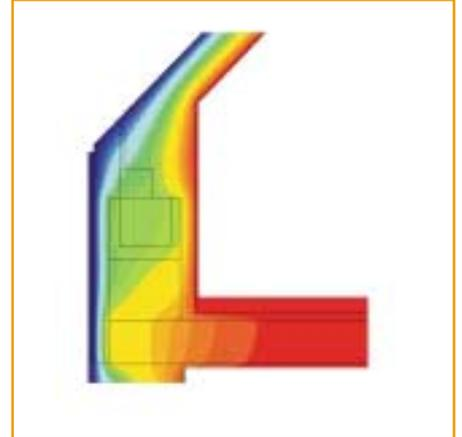
**Detail 6b:** Gleichwertig zu Bild B.49 Beiblatt 2. Außen- und raumseitige 60 mm Dämmung am Kniestock. Außenmaßbezogener Wärmebrückenverlustkoeffizient  $\Psi_e \leq -0,08 \text{ W/(m K)}$ ,  $f_{Rsi,o} > 0,93$ ,  $f_{Rsi,u} > 0,83$ .
