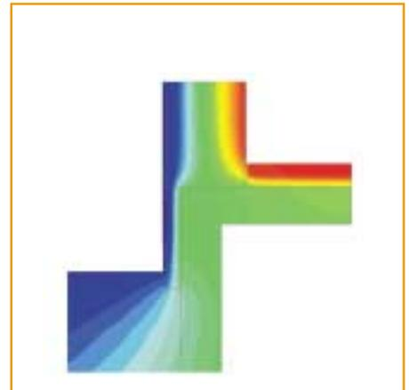
**Detail 1b:** Gleichwertig zu Bild B.7 Beiblatt 2. Betonkeller mit 60 mm Perimeter(Rand)dämmung mit mindestens  $\lambda = 0,04 \text{ W/(m K)}$ . Estrichdämmung mindestens 60 mm. Außenmaßbezogener Wärmebrückenverlustkoeffizient  $\Psi_e \leq -0,08 \text{ W/(m K)}$ ,  $f_{Rsi} > 0,78$ .
