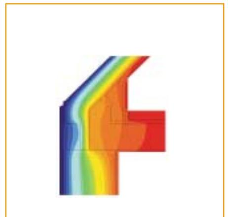
**Detail 7b:** Gleichwertig zu Bild B.51 Beiblatt 2. Deckenabmauerung mit 60 mm Stirndämmung mit  $\lambda \leq 0,04 \text{ W/(m K)}$ . Außenmaßbezogener Wärmebrückenverlustkoeffizient  $\Psi_e \leq -0,03 \text{ W/(m K)}$ ,  $f_{Rsi,u} > 0,86$ ,  $f_{Rsi,o} > 0,88$ .
