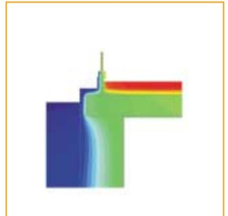
**Detail 5b:** Gleichwertig zu Bild B.36 Beiblatt 2. Unbeheizter Ziegelkeller mit 60 mm Randdämmung analog der Ausführung 1a. Estrichdämmung b mindestens 30 mm. Außenmaßbezogener Wärmebrückenverlustkoeffizient  $\Psi_e \leq -0,12 \text{ W/(m K)}$ .
