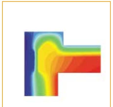
**Detail 7a:** Gleichwertig zu Bild B.45 Beiblatt 2. Deckenabmauerung  $\geq 90 \text{ mm}$  Stirndämmung mit mindestens  $\lambda \leq 0,04 \text{ W/(m K)}$ . Überdämmung des Auflagers mit voller Dämmstärke. Außenmaßbezogener Wärmebrückenverlustkoeffizient  $\Psi_e \leq -0,05 \text{ W/(m K)}$ ,  $f_{Rsi} > 0,81$ .
