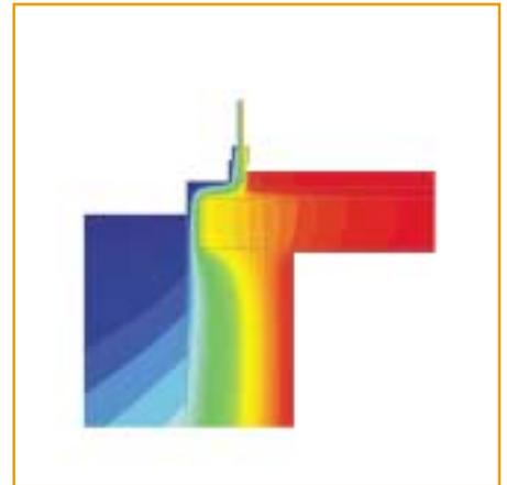
**Detail 5a:** Gleichwertig zu Bild B.35 Beiblatt 2. Beheizter Ziegelkeller analog Detail 2b. Wärmeleitfähigkeit Kellermauerwerk höchstens  $0,24 \text{ W/(m K)}$ . Auch möglich mit Abmauerstein. Damit ist bewehrtes Mauerwerk möglich. Außenmaßbezogener Wärmebrückenverlustkoeffizient  $\Psi_e \leq 0,14 \text{ W/(m K)}$ ,  $f_{Rsi,u} > 0,85$ .
